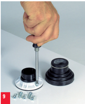
9. Schrauben eindrehen, ohne diese zu überdrehen.
