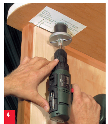
4. Mit dem Kreisbohrer ein Loch von \varnothing 38 mm von unten bohren.
