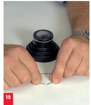
19. Wenn notwendig, Ringfeder durch Abzwicken (ca. 2 mm) nachspannen.
