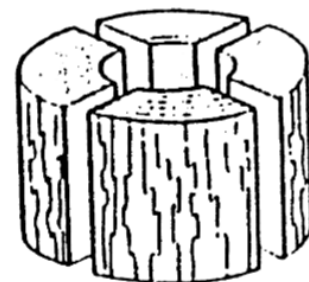
Dachverstärkung in Form eines Holzringes
